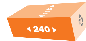
NF Normalformat 240 x 115 x 71 mm
